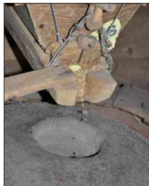
KORN: Her kan ein sjå korleis kornet kjem ut av trakta og ned i kverna.
